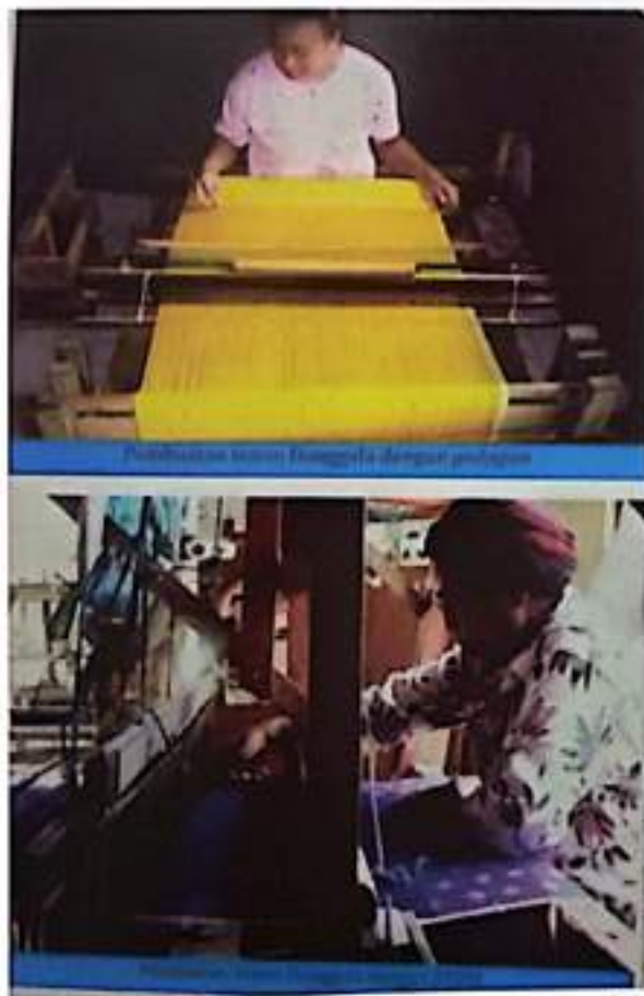
Gambar 155: Pembuatan tenun Donggala dengan gedogan dan ATBM Bahan dasar kain tenun Donggala adalah benang kapas, benang katun, dan benang pakan.
